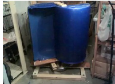
Turbina Savonius con bidone grande e alternatore (corso lungo)
