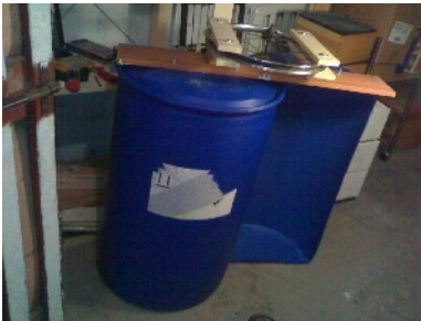
Turbina Savonius con bidone grande e alternatore (corso lungo)
